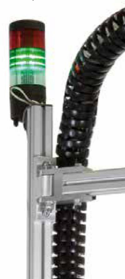
Sygnalizator wskazujący stan roboczy
