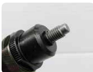
Sprężynująca tuleja środkująca gwarantuje optymalne wpasowanie nakrętki wbijanej.
