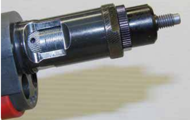
Zamontowany zestaw do przezbrojenia
